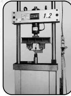
▲ MTS-Prüfrahmen für Ermüdungsprüfungen
